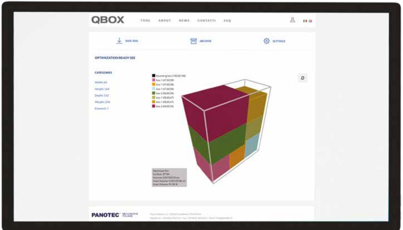
**Logiciel d'optimisation des volumes Calcule le meilleur positionnement des articles, dans une ou plusieurs boîtes, à partir d'une liste d'éléments devant être emballés ensemble.**
