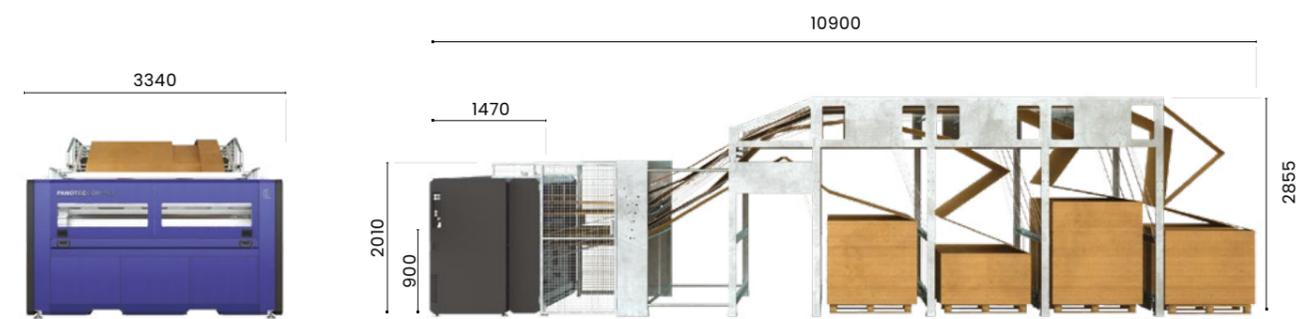
Layoutbeispiel: Compack mit automatischem Einzugssystem
