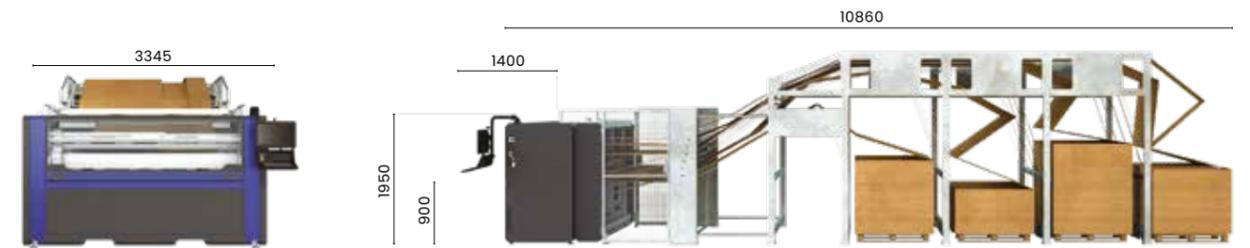
Layoutbeispiel: Evo mit automatischem Einzugssystem
